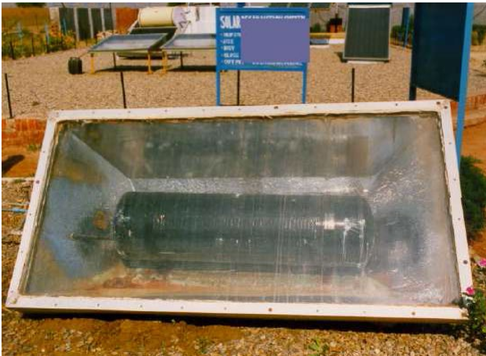
Izgled jednog prijemnika-rezervoara sunčevog zračenja.
